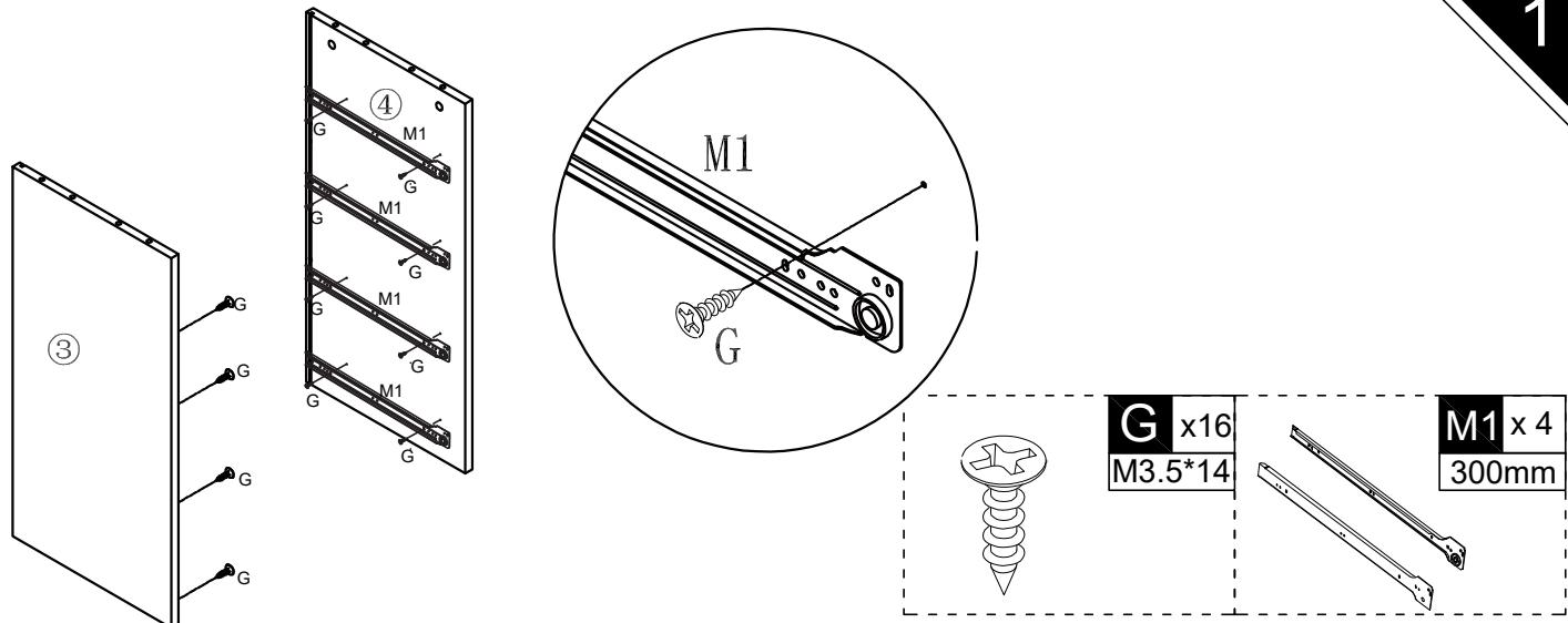
**EN** Please find the exact hole for installation, otherwise it will be misaligned. The screws on the drawer slide must be leveled , otherwise it will affect the smoothness of the d rawer. **FR** Identifiez le trou exact pour l'installation, sinon il sera mal aligné. Les vis de la glissière du tiroir doivent être nivelées, sinon cela affectera le fonctionnement du tiroir.
