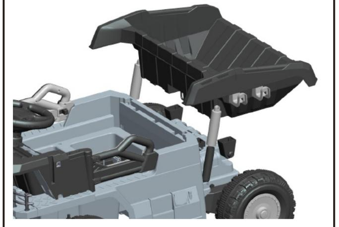
Placez la benne basculante à l'endroit indiqué sur la photo.
