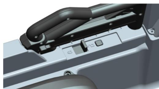
L'interrupteur doit être verrouillé lorsque la benne décapeuse est chargée ; le bouton de la benne basculante sur le tableau de bord ne fonctionne pas. Lorsque vous souhaitez décharger, vous devez déverrouiller l'interrupteur.
