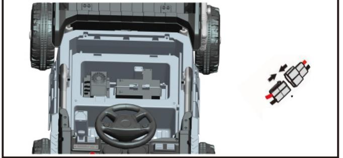
Branchez le connecteur de la batterie à la borne du corps du véhicule, en faisant correspondre les couleurs.
