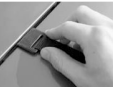
Reinigen Sie die miteinander in Berührung kommenden Flächen am Träger und Fahrzeuge vorher von Schmutz und Staub.
