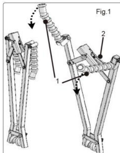
3.4 Drücken Sie auf die Zentralverriegelung, bis die Verriegelung (Abb.1.2) in die verriegelte Position einrastet.
