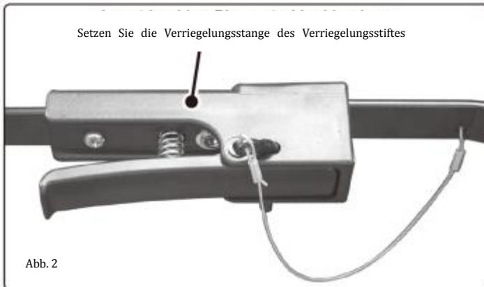
3.7 Um den Träger zu entfernen, entfernen Sie den Sicherheitsverriegelungsstift und drücken Sie den Hebel auf die Zentralverriegelungsstange, während Sie den Verriegelungsstab nach oben ziehen. Die Verriegelungsstange wird nun nach oben geklappt, wodurch der Träger von der Kupplungskugel gelöst wird.
