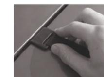
Hängen Sie den Haken an der Oberkante des Fahrzeugs an der Oberkante des Kofferraumdeckel ein
