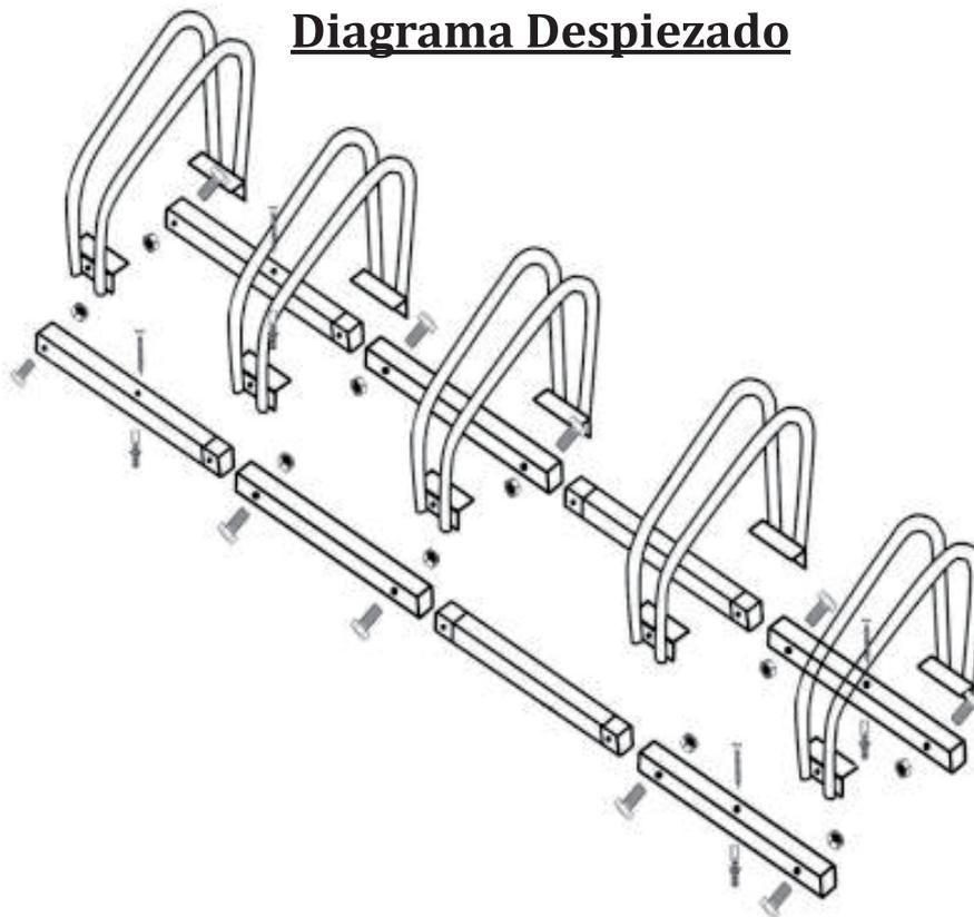
***Nota: El diagrama despiezado es sobre el portabicicletas de 5 rejillas. La estructura principal de portabicicletas es la misma en todas las variaciones.***
