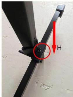
3. Fissare C e D con la vite F e inserirlo nel telaio inferiore come mostrato di seguito
