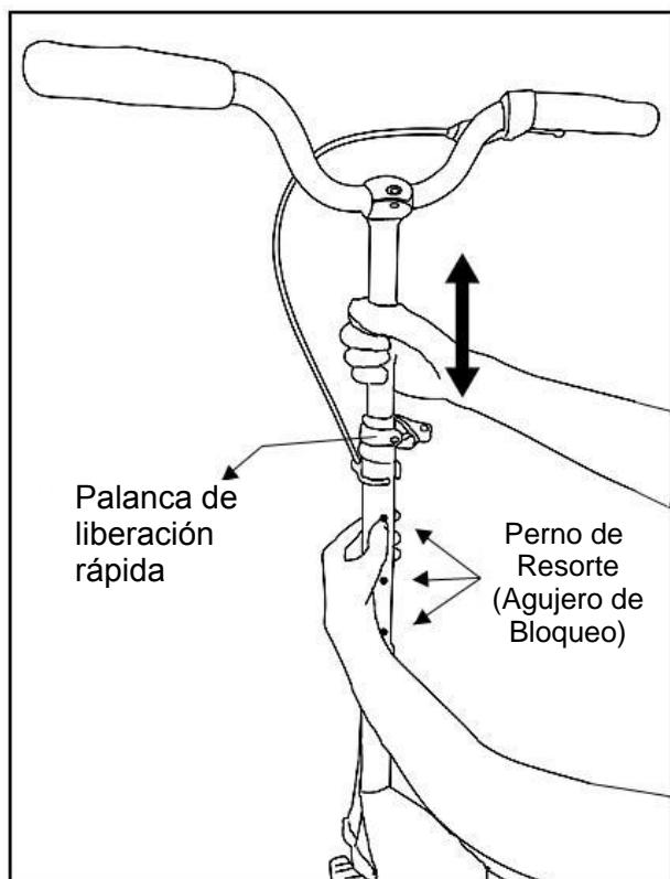
Este scooter puede ajustar la altura de sí mismo para adaptarse a diferentes jugadores. Primero suelte la palanca de liberación rápida, empuje el perno de resorte con una mano, sostenga el tubo de ajuste para empujar hacia arriba o hacia abajo con la otra mano. Haga el Perno de Resorte en uno de los agujeros de bloqueo. Para lanzar la altura diferente. Finalmente apriete la palanca de liberación rápida, asegúrese de que el tubo de ajuste no se pueda mover.
