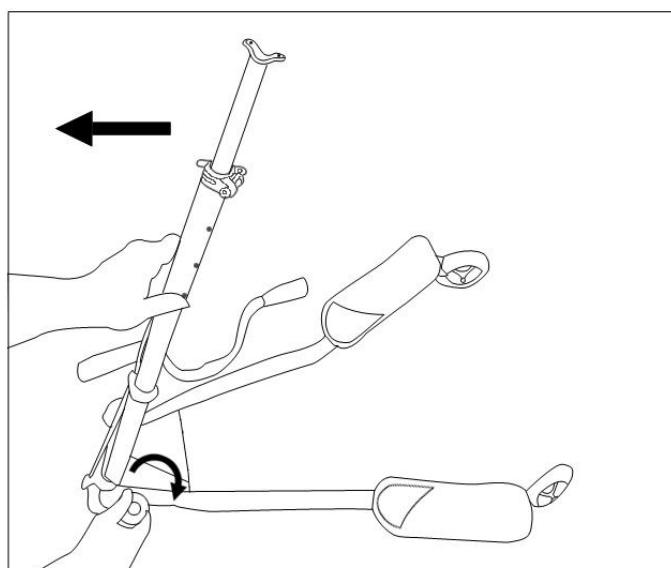
Sujete el tubo de dirección con una mano, levántelo hasta el despliegue completo y atornille ambas perillas con la otra mano en sentido horario. Debe asegurarse de que ambas perillas estén apretadas completamente.
