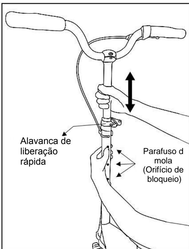
Esta trotinete pode ajustar a altura de si mesma para se adequar a diferentes utilizadores. Primeiro soltar a alavanca de desbloqueio rápido, empurrar o parafuso de mola com uma mão, segurar o tubo de ajuste para empurrar para cima ou para baixo com a outra mão. Colocar o parafuso de mola num dos orifícios de fecho. Para libertar a altura diferente. Finalmente, apertar a alavanca de desbloqueio rápido, certificar-se de que o tubo de ajuste não se pode mover.
