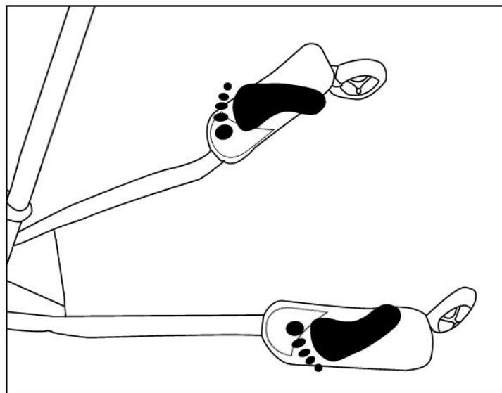
2. Balançar a parte inferior do corpo para a esquerda e depois para a direita. Repita para fazer estas ações, e então a trotinete avançará fácil e continuamente.
