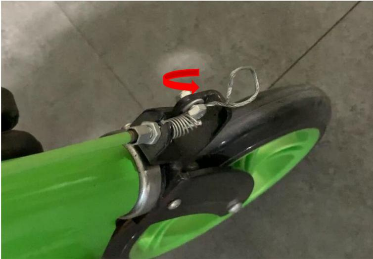
2. Vous pouvez serrer le câble de frein dans le sens de la flèche et en même temps serrer l'écrou
