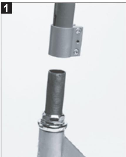
Coloque la barra en forma de T sobre el tubo de la horquilla, empuje la barra en forma de T hacia abajo hasta que toque la parte superior del cabezal.
