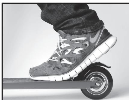
Utilice el talón de ese pie, aplique presión GRADUALMENTE en la parte superior del mecanismo de freno. Así reducirá su velocidad y finalmente lo detendrá.
