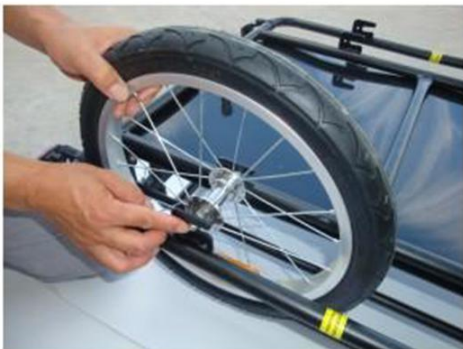
A. mettez la roue dans le cadre comme image
