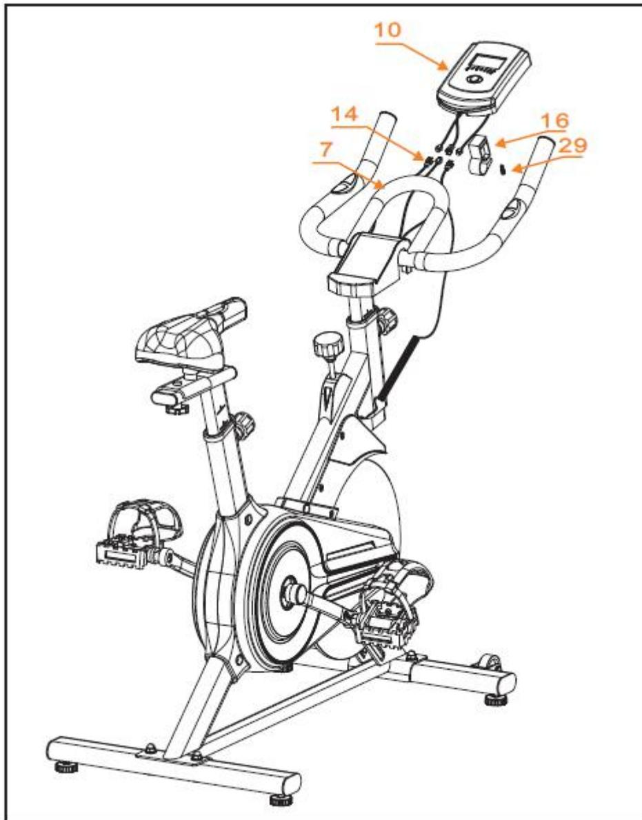
FISSARE LA POSTAZIONE DI PLASTICA DEL MONITOR (16) AL MANUBRIO (7) CON LE VITI (29). METTERE IL MONITOR (10) SULLA POSTAZIONE (16), POI COLLEGARE IL FILO DEL SENSORE. UNIRE IN SEGUITO IL FILO DEL SENSORE (14). LE INTERFACCE SONO CORRISPONDENTI.
