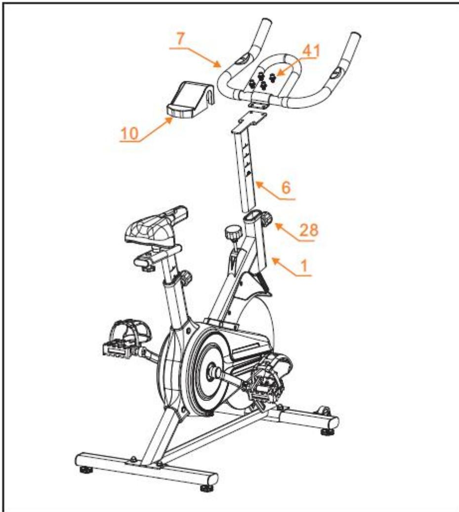
COME MOSTRA L'IMMAGINE, FISSARE IL MANUBRIO (7) CON 2 VITI (4110) NELLO SCOMPARTIMENTO ADATTO (6) E POI INSERIRLE NELLA STRUTTURA PRINCIPALE (1), UTILIZZANDO UNA MANOPOLA DI TRAZIONE DEL PERNO (28). FISSARE STRETTAMENTE PRESSANDO SUL MANUBRIO.
