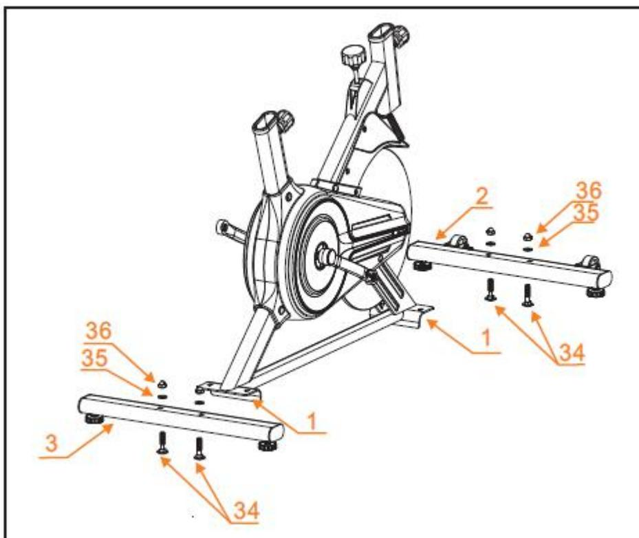
COME NELL'IMMAGINE, INSERIRE LE 4 GUARNIZIONI (34) SUI STABILIZZATORI ANTERIORI E POSTERIORI, INSIEME ALLA STRUTTURA PRINCIPALE (2/3). METTERE LA GUARNIZIONE IN ESSA (35), E FISSATELA CON UN DADO A CAPPELLO (36).
