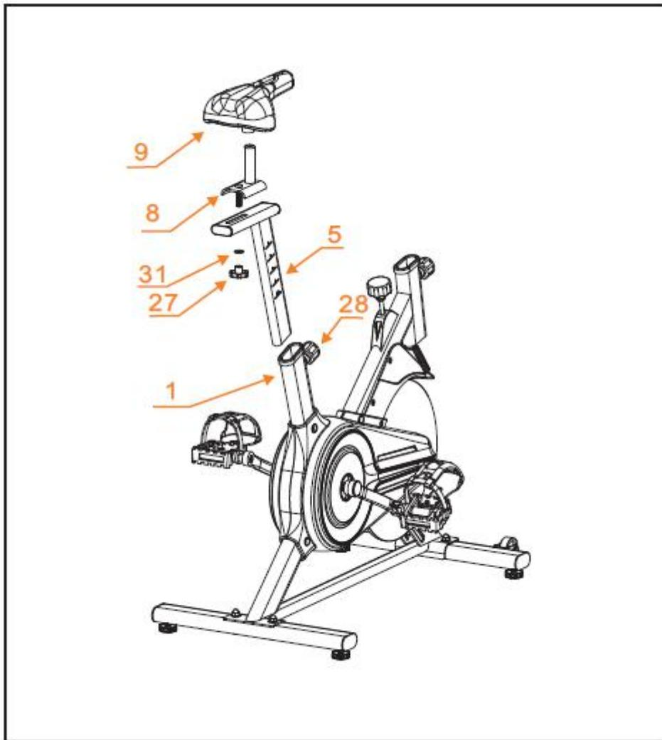
INSERIRE IL REGGISELLA (5) NELLA STRUTTURA PRINCIPALE (1). FISSARE CON LA MANOPOLA A FORMA DI PRUGNA (28) E POI METTERE IL SEDILE (8) SUL REGGISELLA (5). FISSARE CON IL CUSCINETTO (31) E LA MANOPOLA (27). METTERE IL SEDILE (9) SULLA PARTE PREFISSATA DEL SEDILE (8) CON LA CHIAVE.
