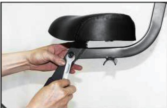
Serrez l'écrou à l'aide de la clé fournie.
