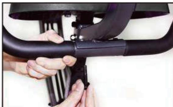
Placez les vis dans les trous et serrez-les à la main.
