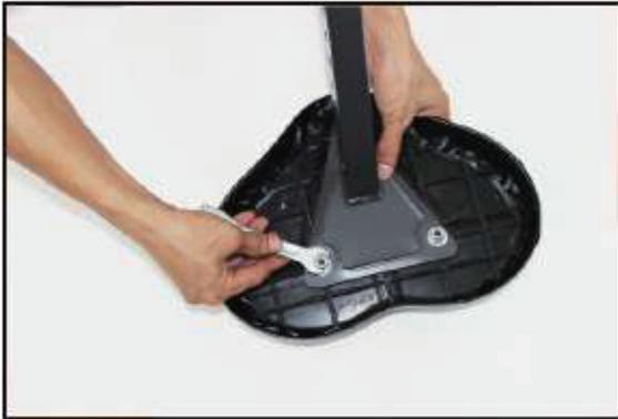
Serrez l'écrou sur la vis avec la clé fournie.
