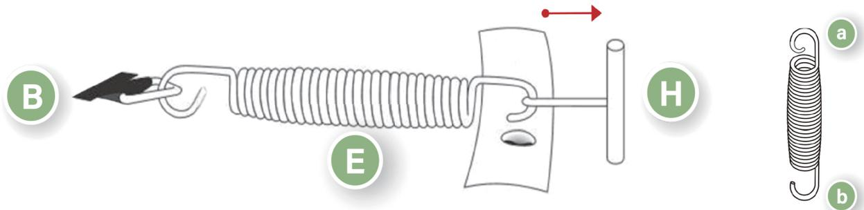
6. Tenez le crochet de montage pour ressorts (H) par-dessus la main et tirez le crochet du ressort vers le rail supérieur (c) comme indiqué sur l'image : faites tomber le crochet dans le trou du cadre jusqu'à ce qu'il s'enclenche complètement, tapez dessus si le crochet n'est pas complètement dans le trou.
