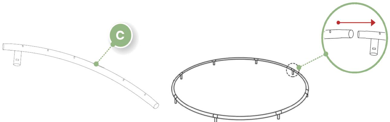
3. Deux personnes sont nécessaires à ce stade pour assembler le trampoline. Une personne soulève les cadres circulaires. L'autre personne soulève les tubes pieds en W pour les mettre en position debout (verticale) et insérez les connecteurs en T dans les tubes pieds en U. Veillez à ce que les trous de verrouillage sont alignés.
