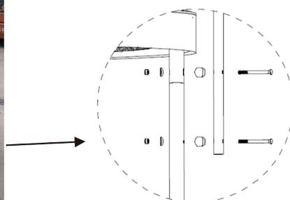
A1 : Montez les piliers supérieurs sur Le tube extension pieds verticale à l'aide de pièces d'entretoise, de rondelle, de vis et d'écrou.
