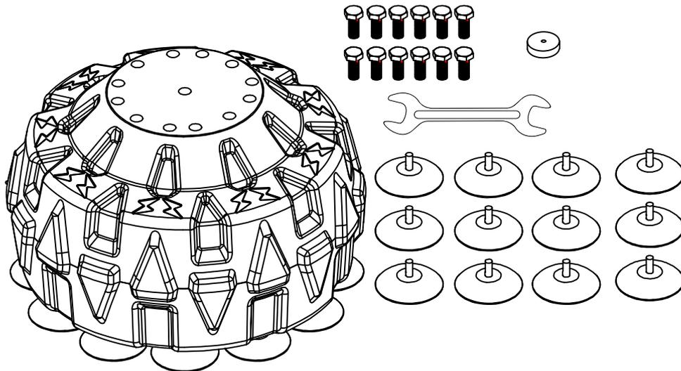
2. Nehmen Sie 12 Saugnäpfe heraus, drehen Sie den Boden des Behälters nach oben, richten Sie die Schrauben auf die Löcher unter dem Boden aus und ziehen Sie sie nacheinander fest.
