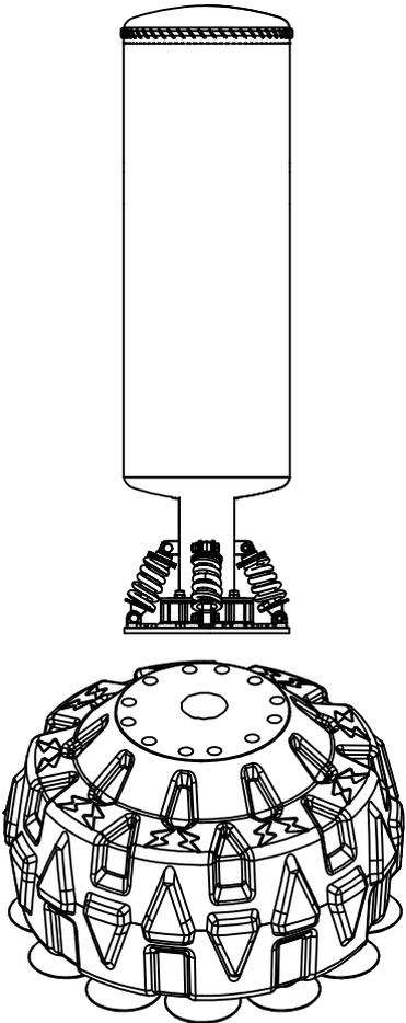
5. Conecte el saco de arena a la base con 12 tornillos y apriételos uno por uno con una llave de instalación.
