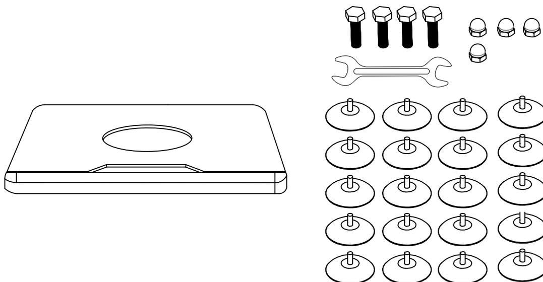
2. Retirez 20 ventouses, tournez le fond du seau vers le haut, alignez les vis avec les trous sous la base, et serrez-les une par une.
