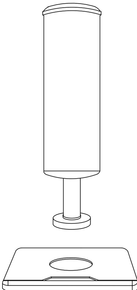
Connectez le sac de sable à la base avec 4 vis, et serrez-les un par un avec une clé de montage.
