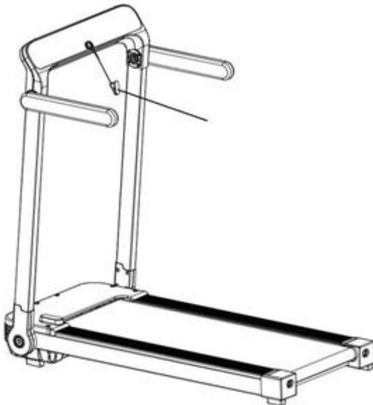
5. Setzen Sie die Sicherheitsverriegelung in den gelben Bereich des Bedienfelds
