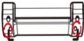
Si la desviación gira hacia la derecha, gire el tornillo izquierdo en el sentido contrario de las agujas de reloj, gire el tornillo derecho en el sentido de las agujas del reloj.
