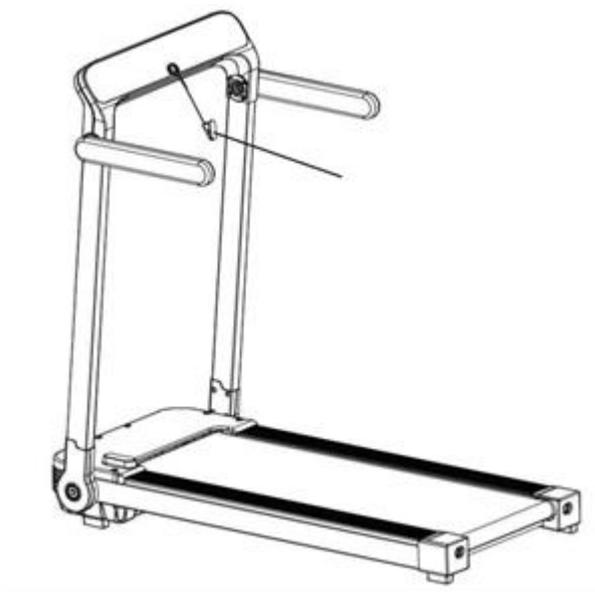
5. Coloque el bloqueo de seguridad en el área amarilla del panel.
