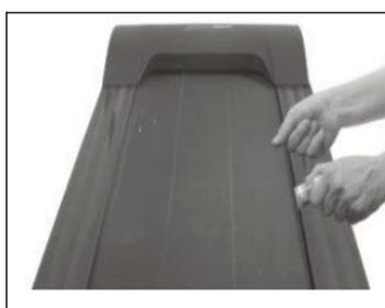
Remontez rigoureusement et doucement la bande de roulement. Ensuite, mettez de l'huile de silicone sur le marchepied. Ensuite, allumez le tapis et laissez le fonctionner 3 min. à vide sans charge. Il est recommandé de faire cette opération tous les 30 jours d'utilisation. Cela augmente la durée de vie de votre appareil et pièces.
