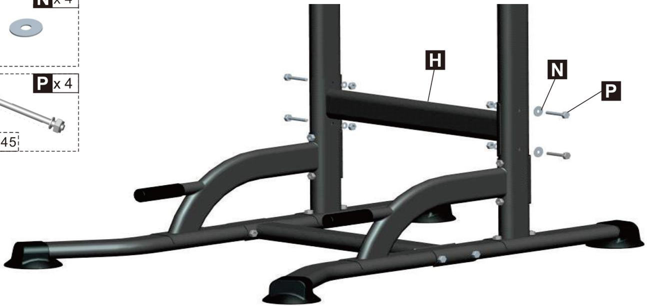
Montaje de tubo de conexión de marco principal: Fije el tubo de conexión del marco principal con tornillo hexagonal M8 X 45 mm.
