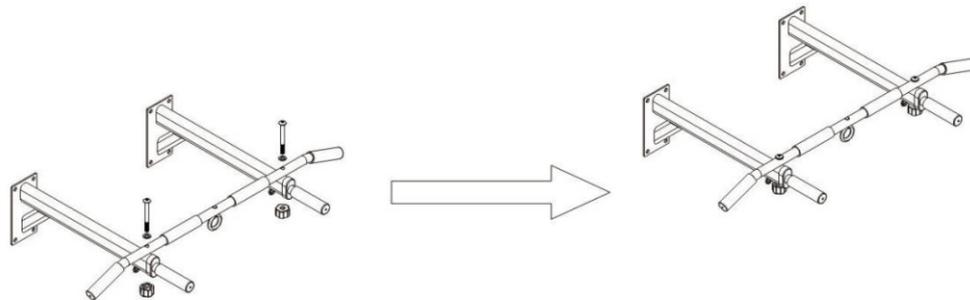
Der letzte Schritt: Bitte bohren Sie mit der elektrischen Bohrmaschine 8 Löcher in die entsprechende Höhe der entsprechenden Wand und befestigen Sie diese mit 8 Dehnschrauben (gemäss den Vorsichtsmassnahmen)
