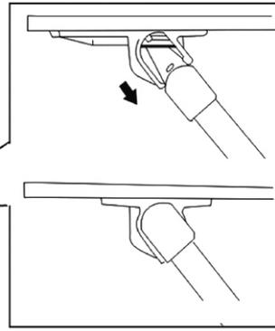
Befestigen Sie den Rahmen mit Tischplatte wie in der Abbildung gezeigt. Bitte achten Sie darauf, dass die Bohrung am Rahmen der Ausbuchtung unter der Tischplatte entspricht.
