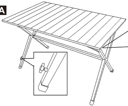
Verwenden Sie den Drehknopf, um die Länge des Fußes an Bodenunebenheiten anzupassen.
