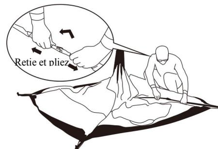
3. Appuyez vers le bas, et si le support supérieur de la cage ne trouve pas le joint de tige, tirez-le avec les deux mains et pliez-le au milieu.
