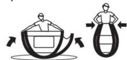
Con una sujeción firme de los 4 postes agrupados, levante la carpa y coloque el extremo en el suelo; debe haber una forma de círculo en el suelo y otro frente a usted.
