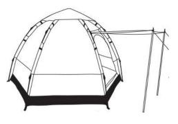
1. Die Heringe der Reihe nach herausziehen, das windsichere Seil entfernen, die Stoffabdeckung und die Dachstahlrohre entfernen
