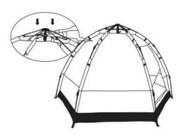
3. Halten Sie die Spitze der automatischen Zeltstange, heben Sie sie an, so dass das Sechseck des Zelts natürlich entfaltet wird, stellen Sie das Zelt ab, stellen Sie sicher, dass die Sechsecke auf dem Boden aufliegen, dann drücken Sie die mittlere Stange in den Hälften, nachdem Sie das "Klicken" gehört haben, ist das Zelt anfänglich installiert.
