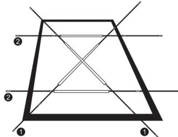
2. Verteilen Sie die vier Stangen durch den Metallstreifen auf dem unteren Konto.
