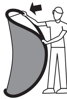
Halten Sie alle acht Stangen fest im Griff, heben Sie das Zelt an und legen Sie ein Ende auf den Boden
