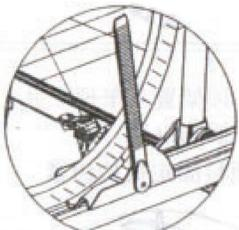
Dispositif de fixation de roues pour roue avant
