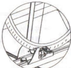
Dispositif de fixation de roues pour roue arrière
