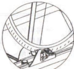
Dispositivo de fijación de ruedas para rueda trasera
