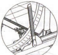
Dispositivo de fijación de ruedas para rueda delantera
