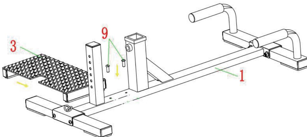
FASE 3: assemblare la parte 3 e la parte 1 utilizzando la parte 9
