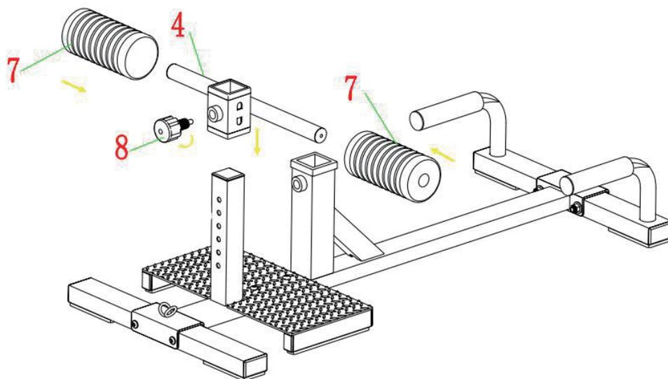
FASE 4: installare Schiuma 7 nella parte 4, e installare la manopola 8 nel tubo verticale, è regolabile l'altezza con la manopola 8.
