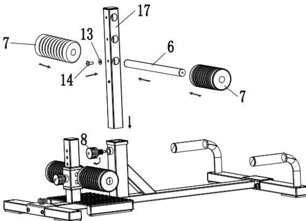
FASE 5: installare Schiuma 7 nella parte 6 e nella parte 17 e fissare la parte 6 con la vite (parte 14)
