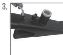
3. Fixez les trois vis (24 M8 X 20) et les trois rondelles (37) à la structure (partie supérieure et inférieure).
