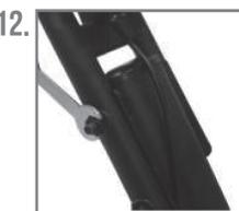
12. Mettez la poignée (6) dans l'ensemble de structure (1) avec deux vis (19), deux rondelles (38) et deux écrou (33)
