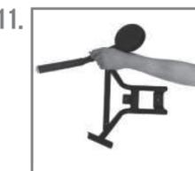
11. Assemblez la poignée en plaçant la structure (6) sur le guidon (7) avec deux rondelles (38) et deux noix (34)
