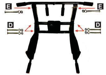
Il processo di fissaggio delle viti prevede che ciascun foro debba essere fissato sulla parte superiore e quindi che tutte le viti debbano essere fissate senza stringerle prima di essere strette tutte insieme in modo da installare il telaio principale.
