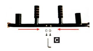
Innanzitutto, unire i tubi di collegamento multifunzionali sinistro e destro, quindi fissare i fori delle viti di allineamento senza stringerle eccessivamente. Se fissato in troppo, avra' un effetto sulla successiva installazione senza problemi!
