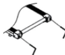
dans le sens des aiguilles d'une montre sur le pied droit. Faites particulièrement attention lorsque vous tendez la bande et assurez-vous que les deux côtés sont réglés de manière synchrone, afin que la bande de course puisse être tendue et ne dévie pas du point central. Si la ceinture de course est trop serrée, réglez la synchronisation gauche et droite dans le sens inverse des aiguilles d'une montre.
