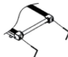
orario di 1/4 di giro, poi ruotare di 1/4 di giro in senso orario sul piede destro. Fare particolare attenzione quando si tira la cinghia e assicurarsi che entrambi i lati siano regolati in sincrono, in modo che il nastro sia ben teso e non si discosti dal centro. Se il nastro scorrevole è troppo teso, regolarne la posizione sinistra e destra in senso antiorario.
