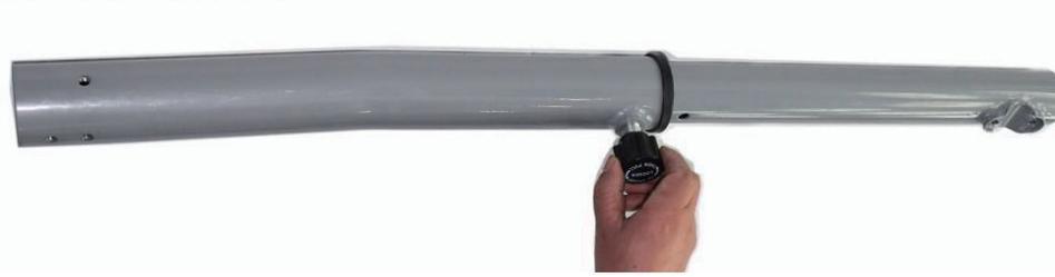
4. Far passare il cavo di collegamento (44) attraverso i tubi del montante.
