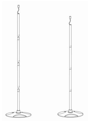
**Schritt 3:** Schließen Sie das Netzkabel zusammen mit Heizkopf und schrauben Ober röhre mit Mittelrohr fest.
