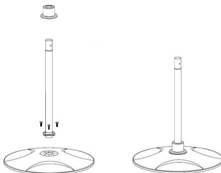
**Schritt 2:** Stecken das Netzkabel in die untere Rohr von der Basis, und ziehen Sie das Netzkabel aus dem mittleren Rohr aus. Halten das Netzkabel, schrauben mittlere Rohr auf Bodenrohr und ziehen richtig fest.
