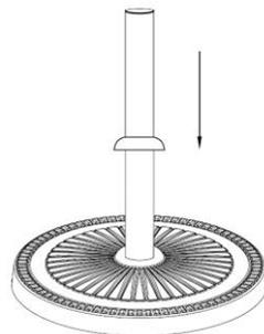
Schritt 3: Führen Sie das Netzkabel durch die Basis und das untere Rohr, und ziehen Sie etwa 2 m Kabel durch.
