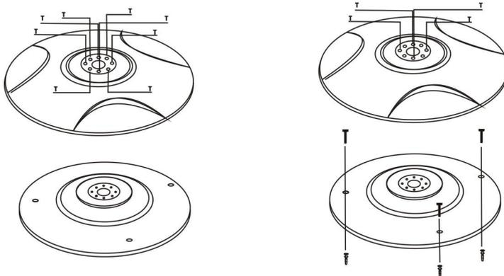
2. Befestigen Sie bitte das untere Rohr mit 4 Stück M6 \* 30mm Schrauben an der Basis.
