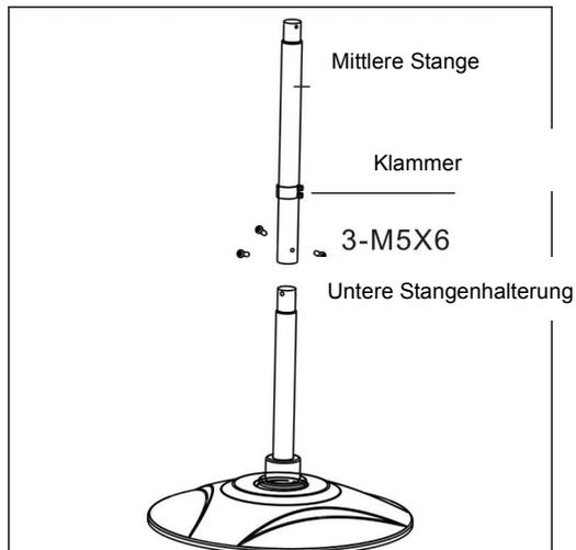
4. Schrauben Sie bitte 3 Stück M5 \* 6mm Schrauben in das mittlere Rohr und legen Sie die Kabelhalterung auf das obere Rohr, bevor Sie das obere Rohr befestigen.
