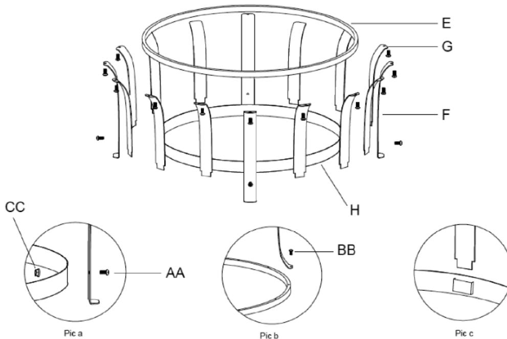
M6 x10mm (BB), vedere la figura B. Ripetere questo passaggio per il resto del telaio.
