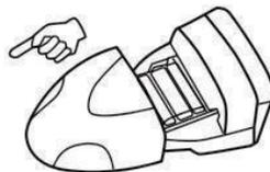
3.2.3 Insérez 6 nouvelles piles dans le COMPARTIMENT DE LA BATTERIE. Il faut prendre soin des symboles de polarités (+ et -) qui sont marqués sur les bornes de connexion du détecteur et des batteries. Les polarités de la batterie doivent correspondre aux polarités des bornes.
