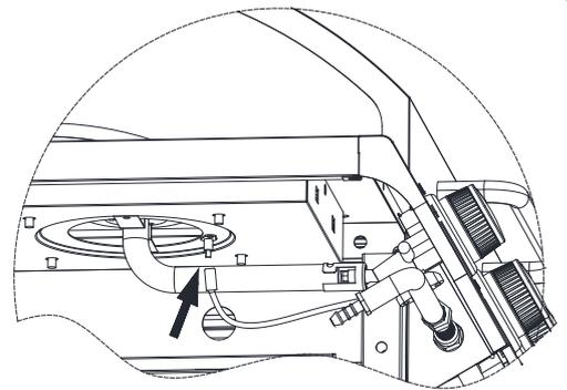
Nach dem Zusammenbau des Seitenbrenners führen Sie bitte den Zünddraht in den Zündstift ein.
