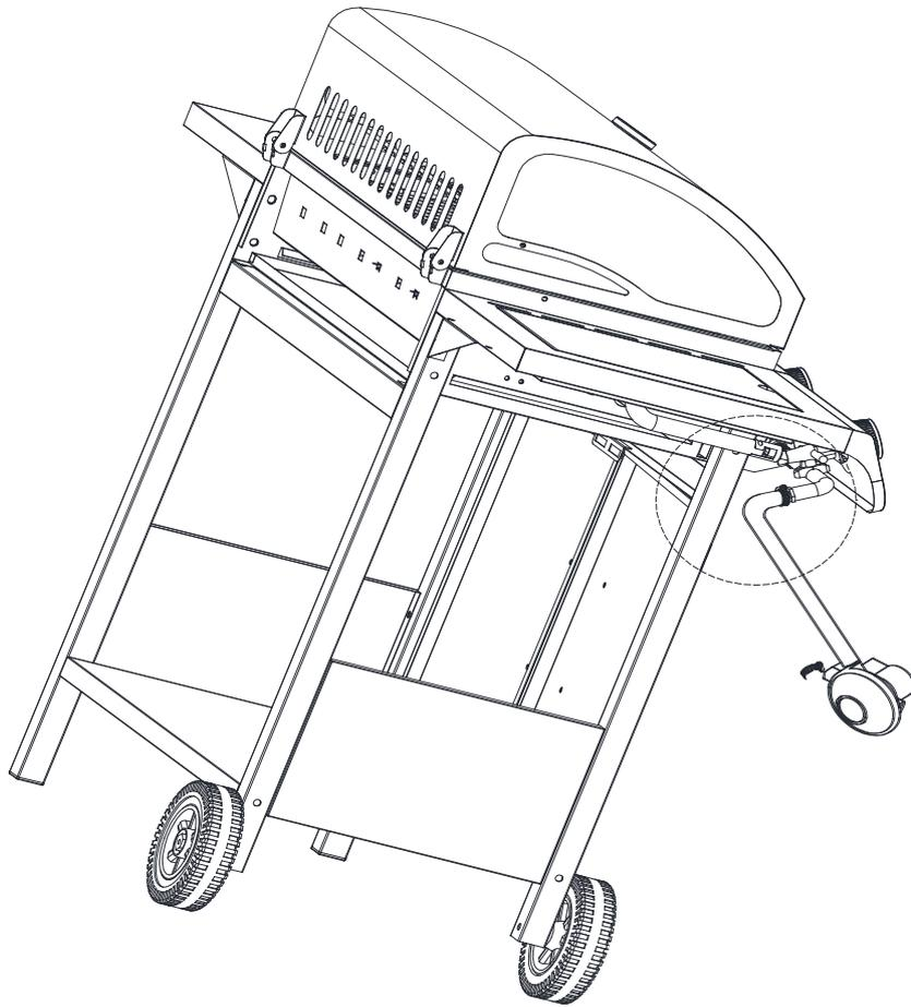
Stecken Sie den Schlauch in den Grillanschluss
