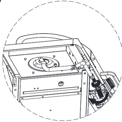
Ziehen Sie die Schraube mit einem Schraubenschlüssel an (Schraubenschlüssel ist nicht im Lieferumfang enthalten).
