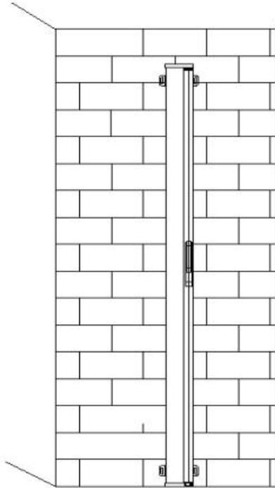
3. Forare con 6 centimetri di profondità dove marcato in precedenza con un diametro di 10 millimetri.
