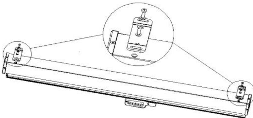
2. Appoggiare il prodotto al muro dove va installato e marcare quattro punti dove fare i fori per le viti di installazione
