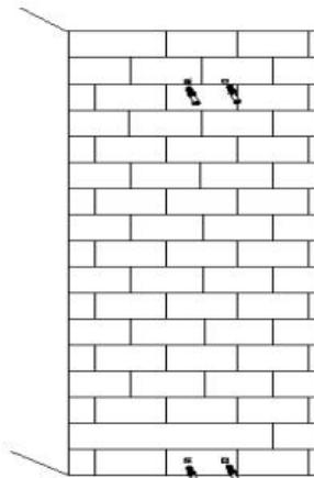
5. Fissare il prodotto a muro con le viti in legno **M6x60** e le rondelle.
