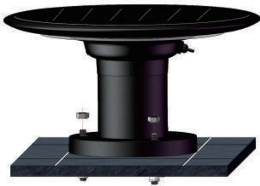
1. Bohren Sie drei Löcher in den Boden, die mit den Schraubenlöchern am Sockel übereinstimmen. Setzen Sie die Dehnschraube ein.
