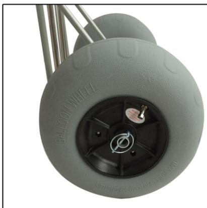
2. Insérez la goupille à dégagement rapide dans l'axe pour verrouiller. Répétez l'opération pour la deuxième roue.
