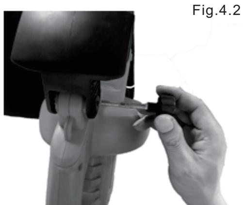
**Fissare la manopola di regolazione (Fig.4)**
