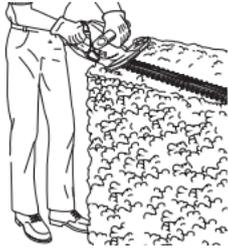
5. Se le lame si inceppano, rilasciare l'interruttore a grilletto e lasciare che le lame si arrestino. Estrarre la batteria prima di tentare di rimuovere l'ostruzione.
