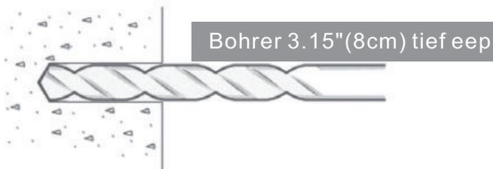
2. Bohren Sie mit einem 0.55"(14mm) Steinbohrer das erste Bolzenloch etwa 3.15"(8cm) tief, wie in der Abbildung dargestellt. Dieses muss durch massiven Ziegelstein oder Beton gebohrt werden, um die notwendige Unterstützung für die Markise zu bieten.
