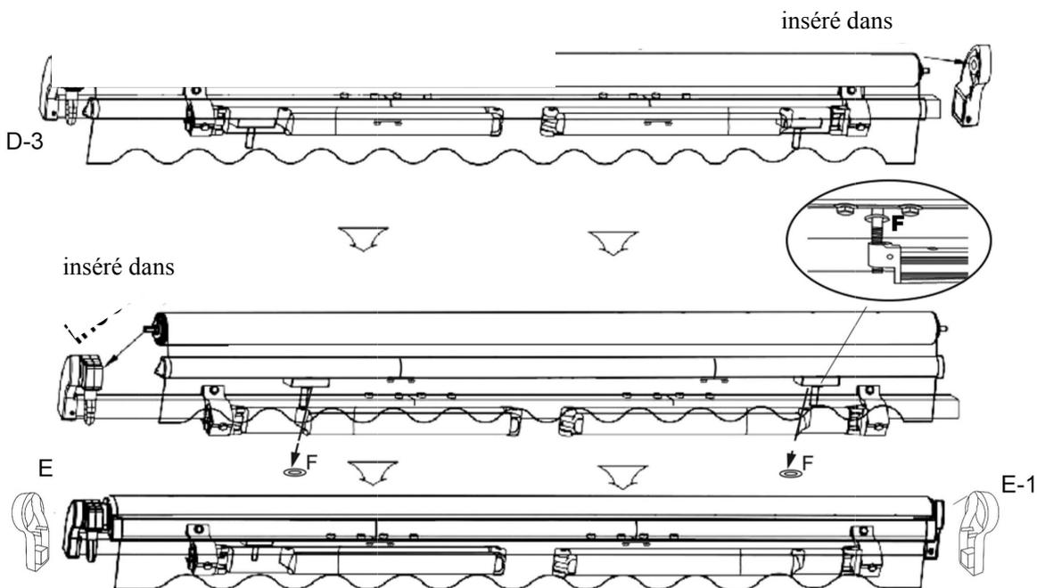
2. Position de réglage du store complet. Vérifiez que les deux bras sont fermement liés à la barre de torsion. Déplacez le support de poignet de la barre avant (Q) jusqu'à ce support du poignet vers le haut à l'aide d'un tournevis. Ne serrez pas complètement ces vis en laissant un espace de 4 mm entre les vis.
