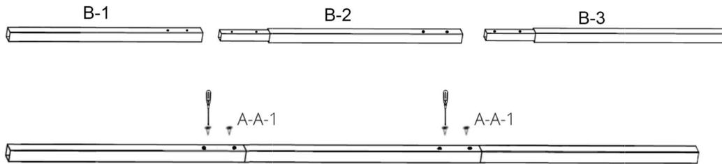
Ensuite, assemblez le bras sur la barre de torsion comme indiqué ci-dessous. Deux bras doivent dans la même direction, la corde de bras ne peut être déverrouillée avant que l'ensemble ne soit terminé.
