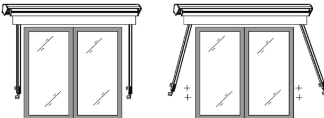
2. Verwenden 8mm Steinbohrer 4 Löcher an den entsprechenden Markierungen an der Wand für die Klammern zu bohren.
