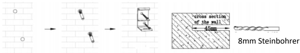
Abbildung 2: Verwenden Sie 8 mm Steinbohrer 4,5 cm tiefe Löcher zu bohren.
